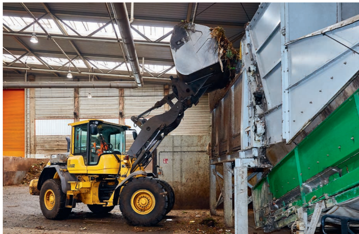
PER RADLADER WIRD DAS ANGELIEFERTE BIOGUT IN DIE SIEBTROMMEL GEGEBEN. DORT WERDEN KLEINE VON GROSSEN BESTANDTEILEN GETRENNT.
